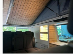
Himmelverkleidung mit LED Beleuchtung (auf Anfrage auch für Aufstelldächer möglich)
